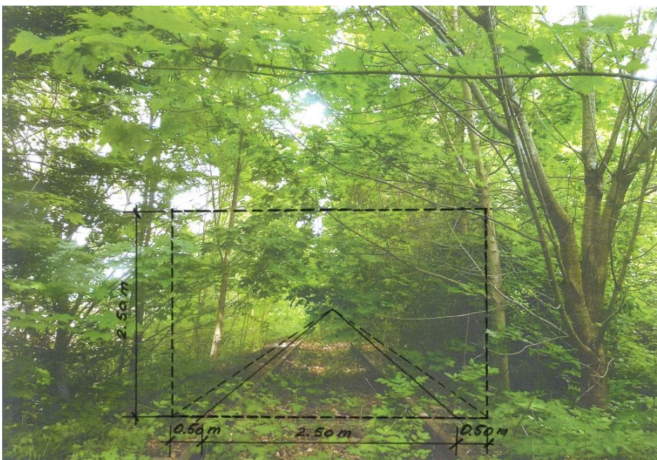
Abbildung 15: Darstellung eines regelgerechten Radweges von 3,50 m Breite und Lichtraumprofil von 2,50 m Höhe in Bestandssituation (ehemalige Bahntrasse mit beidseitigem Gehölzbestand)
