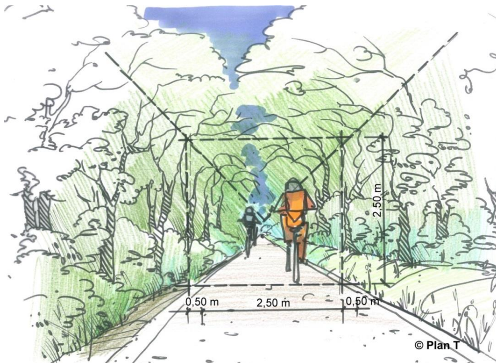
Abbildung 10: Prinzipskizze des empfohlenen Regelquerschnitts von Radwegen auf ehemaligen Bahntrassen
